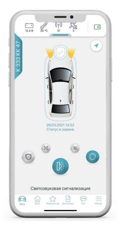
Рисунок 23 - Объект в режиме Управление багажником
