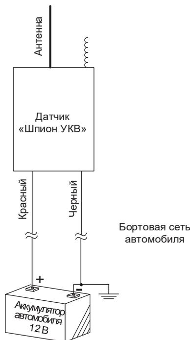
Рис. Г.3 - Схема подключения Шпион УКВ
