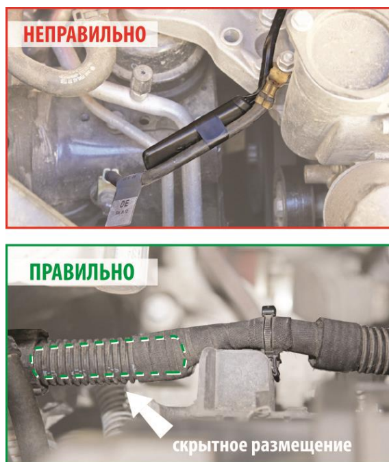
Рис. 1 – Правильность размещения модуля
